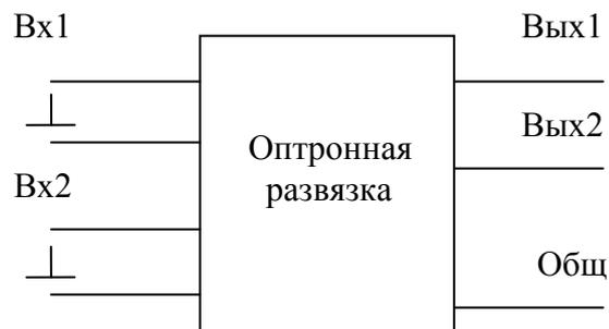
Рисунок 1 – Оптронная развязка
