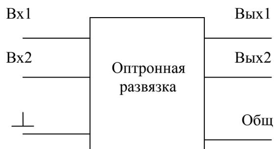
Рисунок 2 – Оптронная развязка (старого типа)
