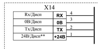
**Рис. Б 4.1.1-3** Схема подключения КСЛ-RS к станциям управления лифтом УКЛ, УЛ, УЭЛ. (Перемычку “232/Т3” установить в положение “Т3”).
