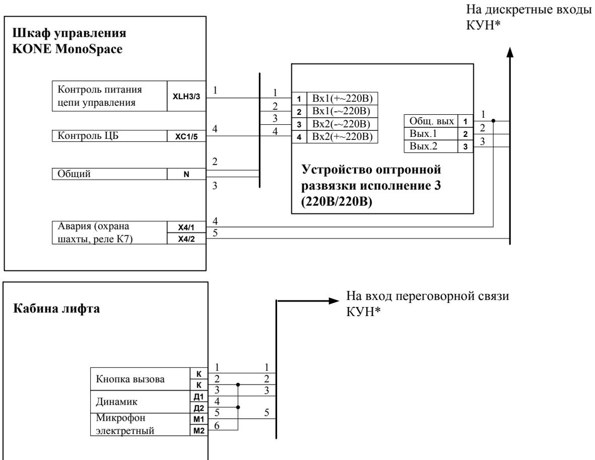
**Рис. Б 4.1.4** Схема подключения станции управления лифтом KONE MonoSpace к КУН\*.
