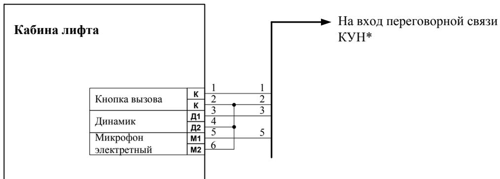
**Рис. Б 4.1.16** Схема подключения станции управления лифтом DAESUNG к КУН\*. (Оптронные развязки установить в шкафу управления).
