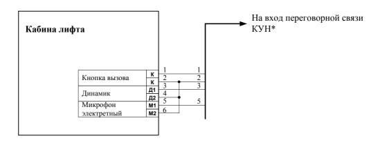
**Рис. Б 4.1.6** Схема подключения станции управления лифтом ALJO к КУН\*. (В качестве кнопки «Вызов» используется кнопка поста приказов «Вызов», при этом перемычки от кнопки необходимо демонтировать. Оптронные развязки установить в шкафу управления). \*КУН-2Д.1, КУН-2ДМ, КУН-IP8, КУН-IP4
