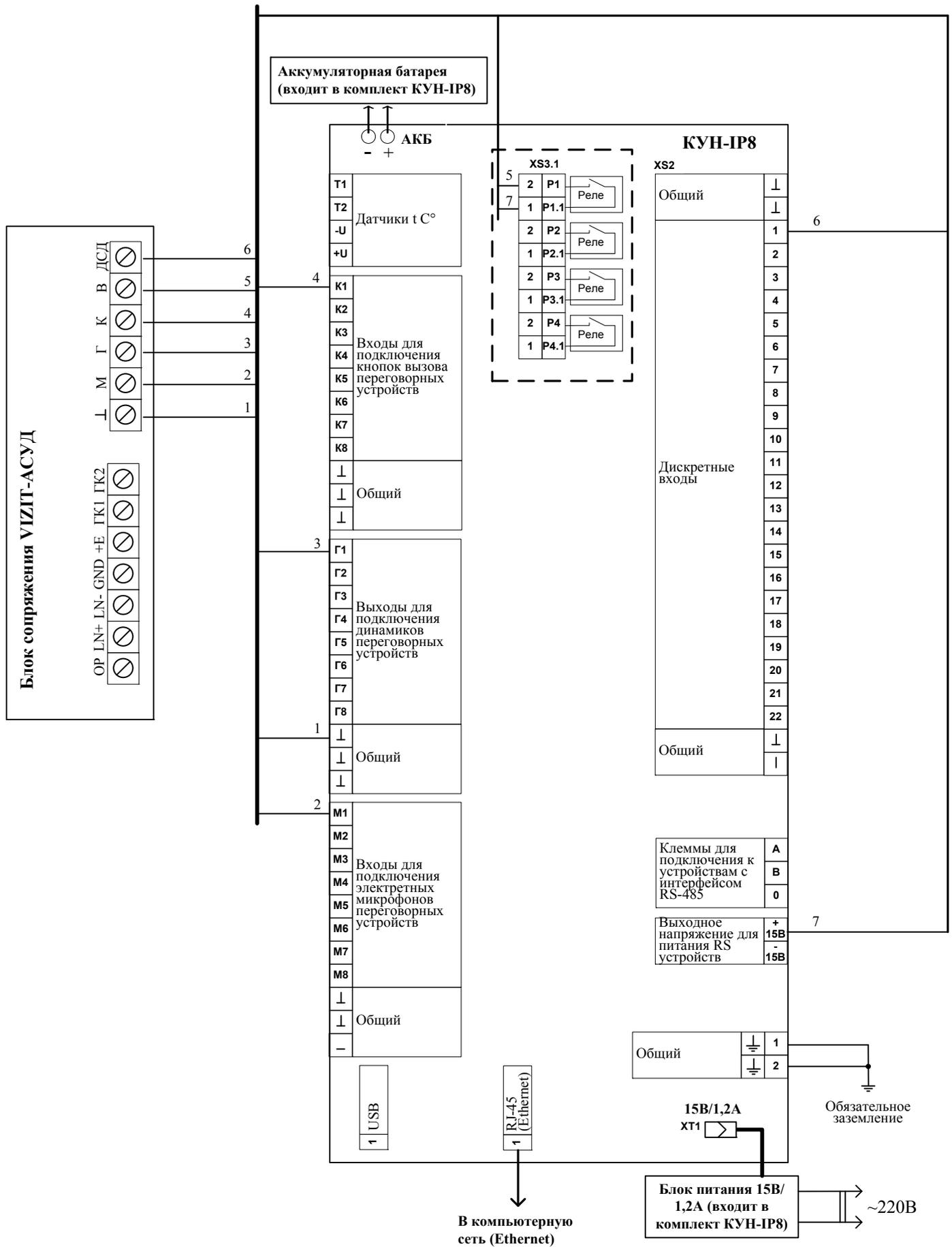
**Рис. Б 4.2.6** Схема подключения Концентратора универсального (КУН-IP8) с блоком сопряжения VIZIT-АСУД домофона VIZIT.
