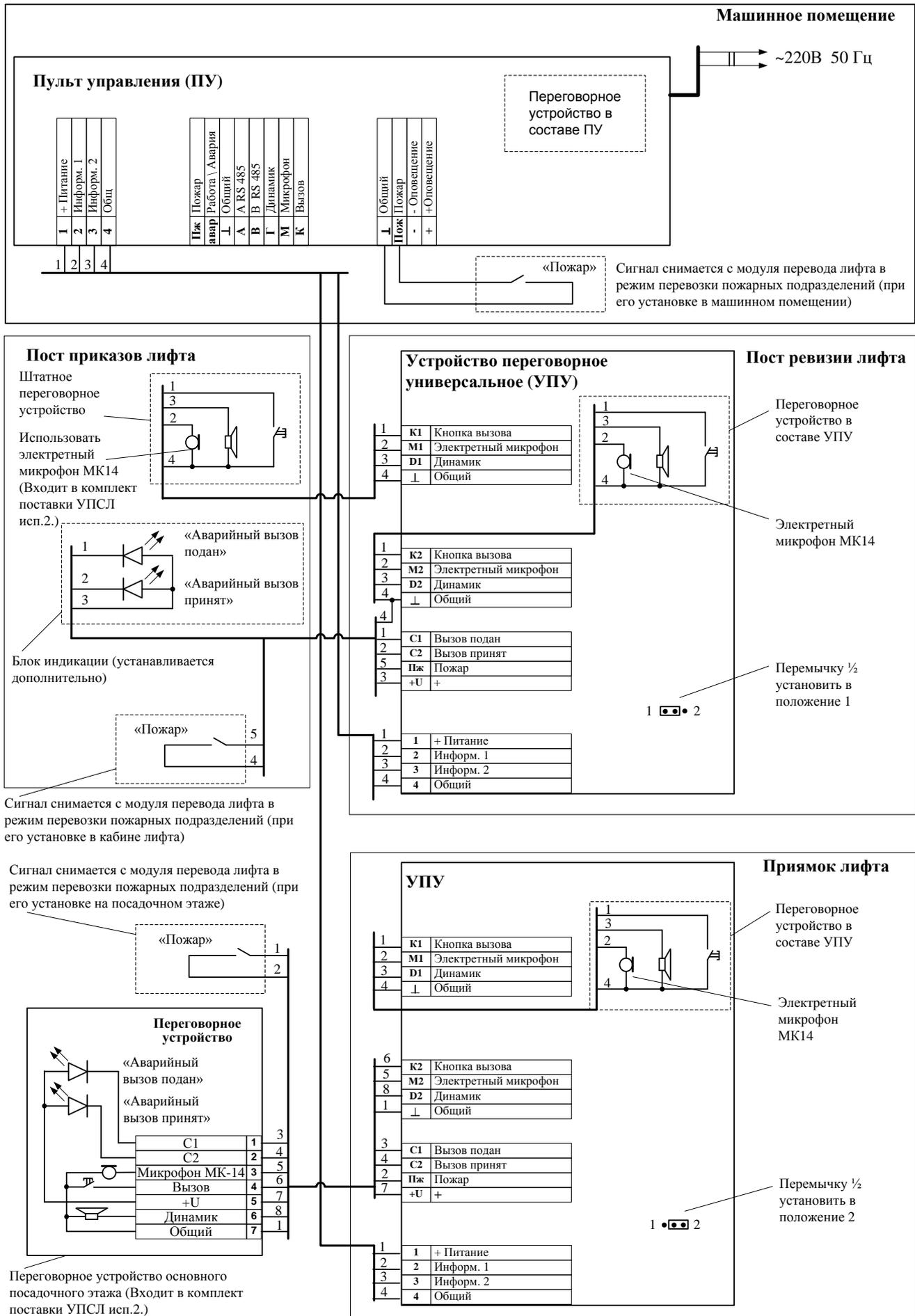
**Рис. 1.2** Устройство переговорной связи лифта исполнение 2 (УПСЛ исп.2). Ремонтная связь лифта, связь с помещением для обслуживающего персонала, связь лифта для пожарных.
