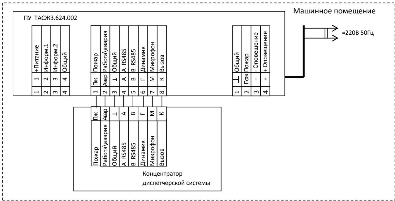
Рис. Схема подключения к диспетчерским системам. Остальные соединения блока лифтовой диспетчерской системы выполнять согласно схемам диспетчерских систем.
