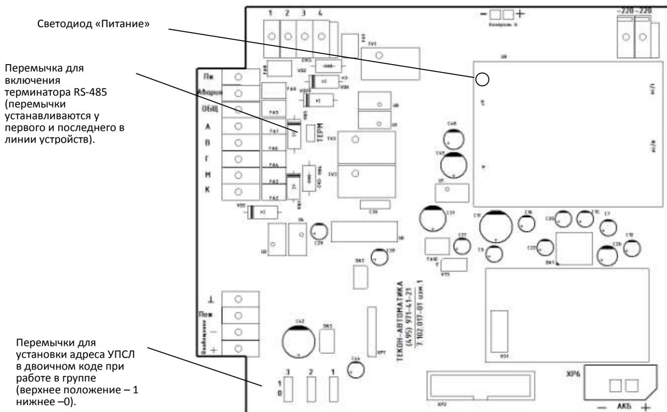
Рис. Схема расположения переключек и контакторов на ПУ
