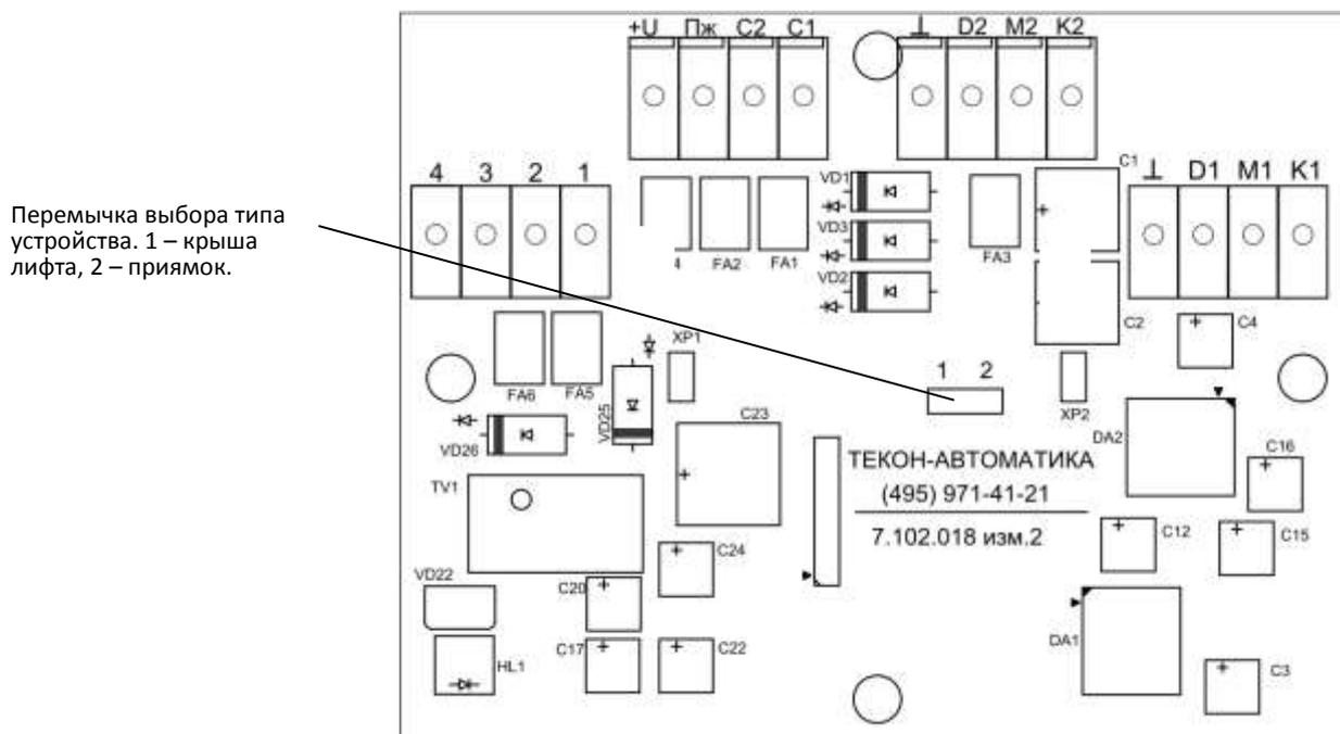
Рис. Схема расположения переключек и контакторов на усилителе приемопередающем
