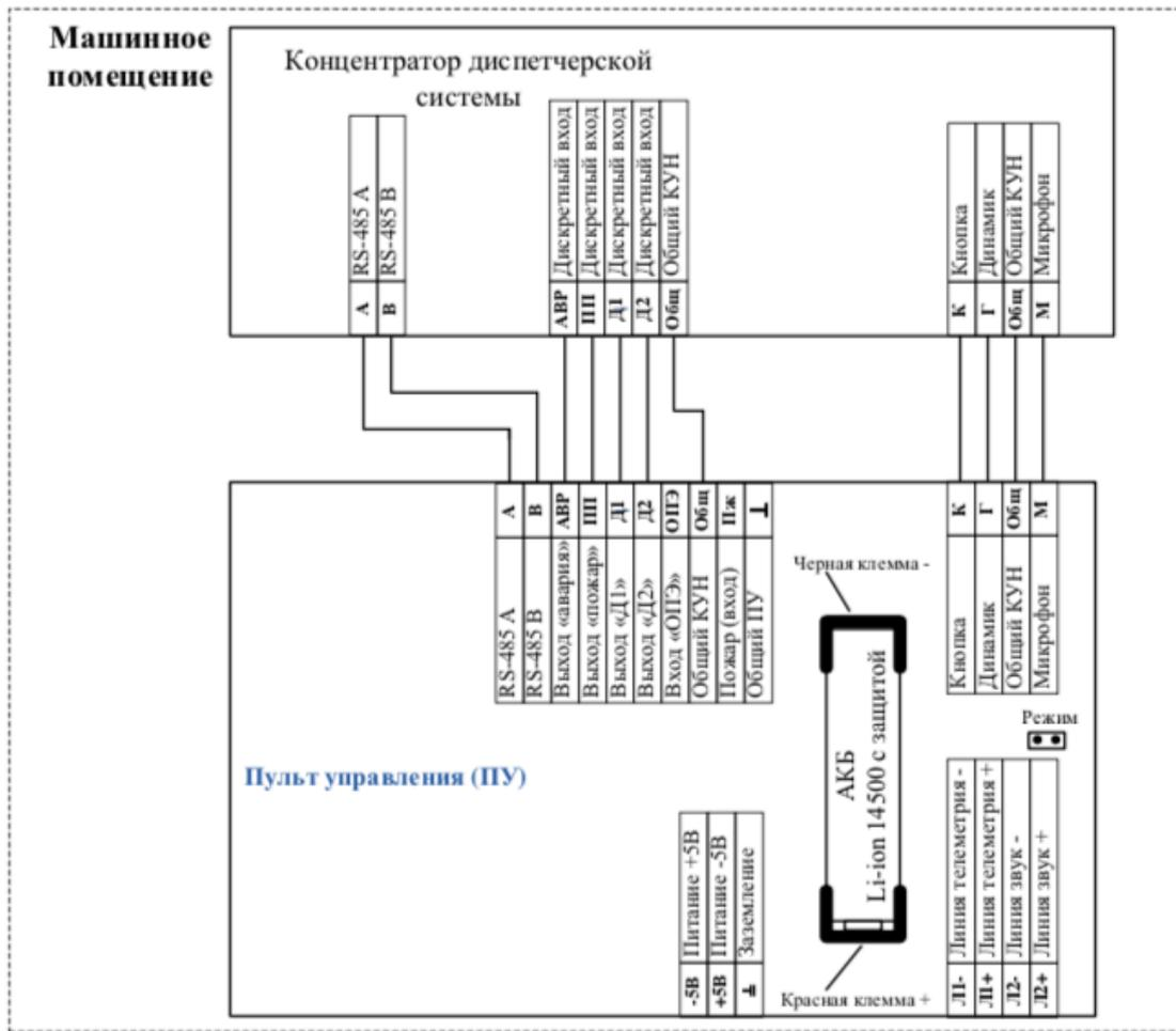
Рисунок 1 – Схема подключения ПУ-М к системе диспетчеризации
