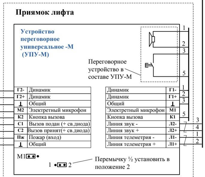
**Рис. Б 2.20.4-2** Устройство переговорной связи лифта - М исполнение 2 (УПСЛ-М исп.2). В комплект входит ПУ-М – 1шт., УПУ-М – 2 шт., ПККЛ-М – 1шт, ПГУ-М ОПЭ –1шт.). Основные функции: связь лифта для пожарных, ремонтная связь лифта, связь с помещением для обслуживающего персонала.
