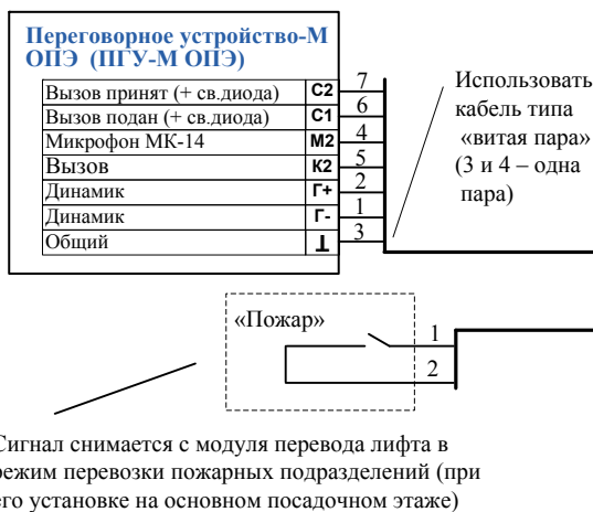
Рис. Б 2.20.4 Устройство переговорной связи лифта - М исполнение 2 (УПСЛ-М исп.2). В комплект входит ПУ-М – 1шт., УПУ-М – 2 шт., ПККЛ-М – 1шт, ПГУ-М ОПЭ –1шт.). Основные функции: связь лифта для пожарных, ремонтная связь лифта, связь с помещением для обслуживающего персонала.
