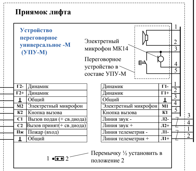
Рис. Б 2.20.4 Устройство переговорной связи лифта - М исполнение 2 (УПСЛ-М исп.2). В комплект входит ПУ-М – 1шт., УПУ-М – 2 шт., ПККЛ-М – 1шт, ПГУ-М ОПЭ –1шт.). Основные функции: связь лифта для пожарных, ремонтная связь лифта, связь с помещением для обслуживающего персонала.
