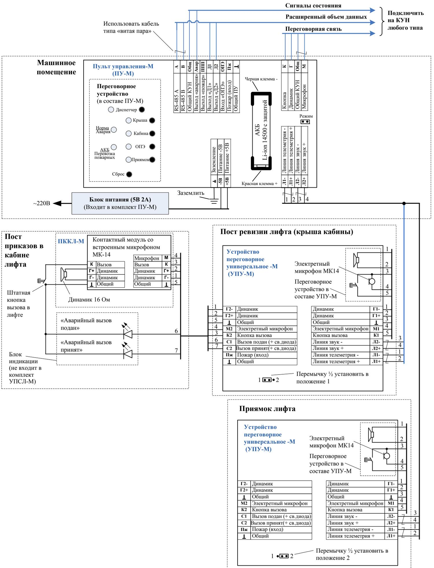
**Рис. Б 2.20.3** Устройство переговорной связи лифта - М исполнение 1 (УПСЛ-М исп.1). В комплект входит ПУ-М – 1шт., УПУ-М – 2 шт., ПККЛ-М – 1шт.
