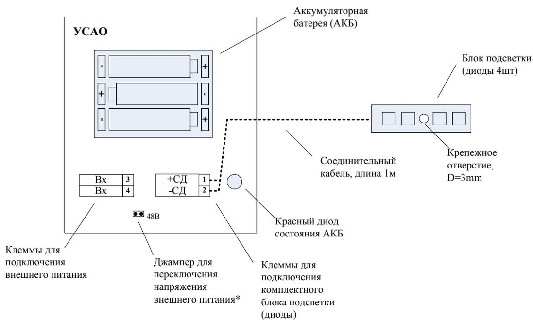
**Рис. Б 3.7.1** Схема подключения устройства аварийного освещения кабины лифта (УСАО)
