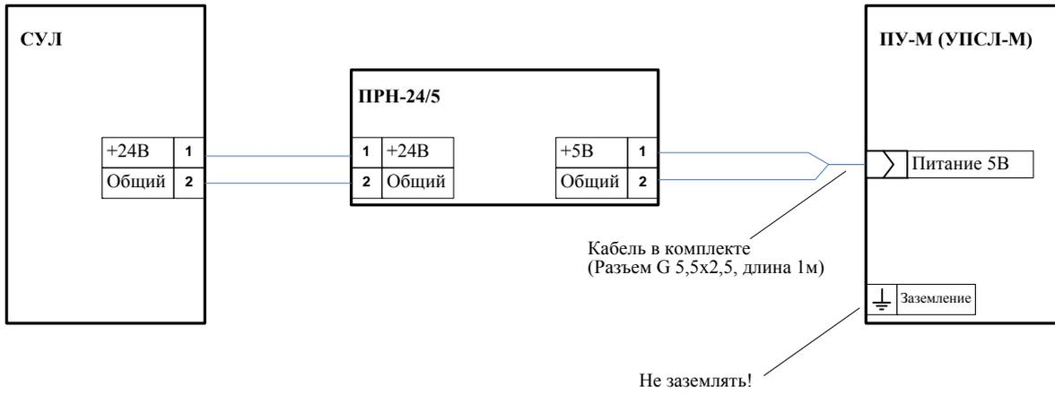
**Рис. Б 3.9.1** Схема подключения преобразователя напряжения с 24В на 5В (ПРН 24/5)
