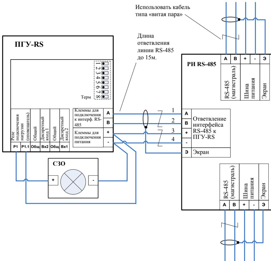
**Рис. Б 2.22.3** Схема подключения ПГУ-RS и светозвукового оповещателя (СЗО) через разветвитель интерфейса RS-485 (РИ RS-485). При использовании экранированного кабеля экраны подключать к контактам «Э».
