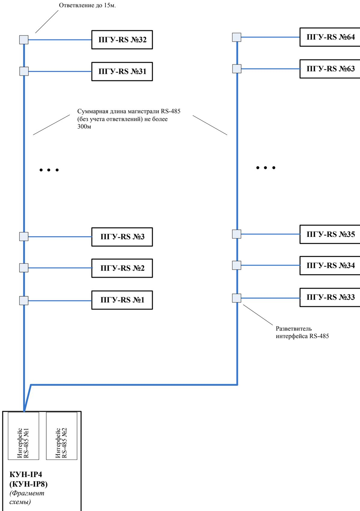
**Рис. Б 1.14** Структурная схема подключения ПГУ-RS к КУН-IP4 (КУН-IP8) с ответвлениями от магистрали RS-485. Цепи питания и светозвуковые оповещатели (СЗО) не показаны.
