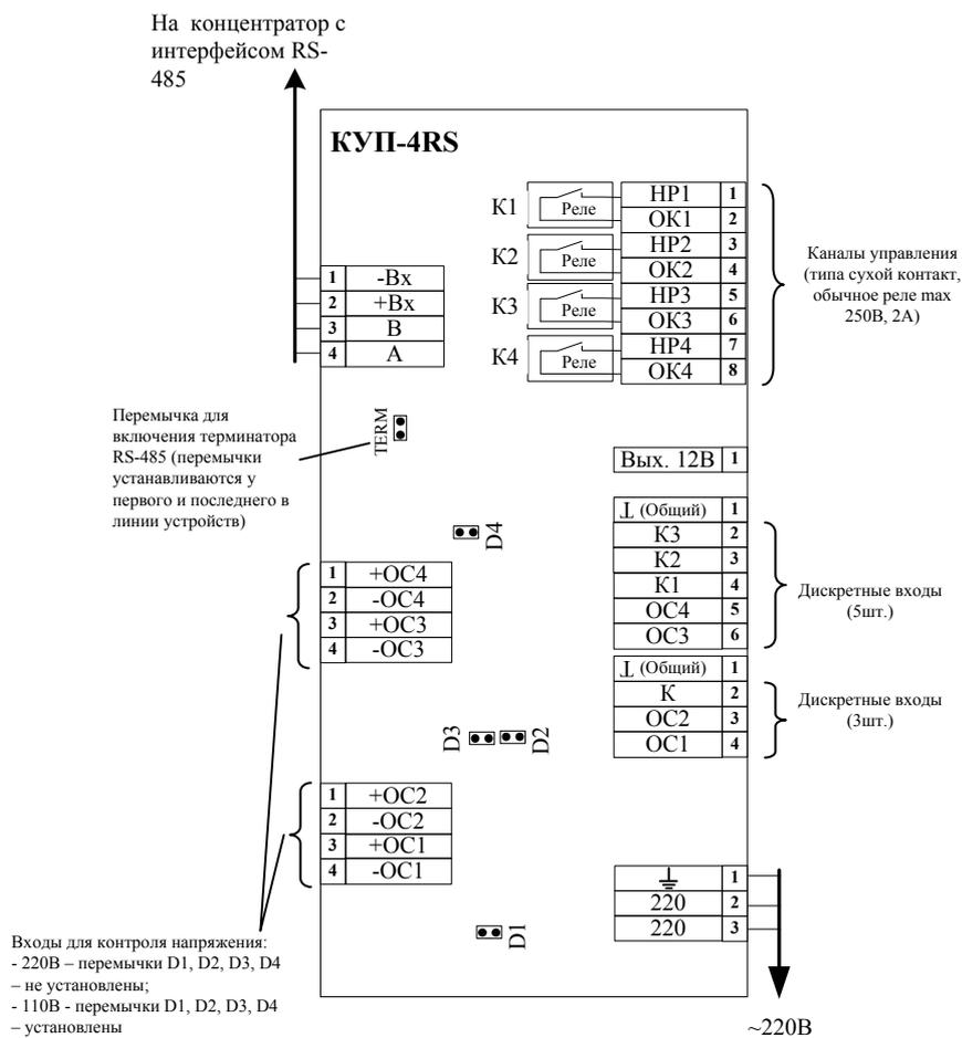
Рис. Б 2.5.5 Схема подключения концентратора управляющего-4 RS (КУП-4 RS).
