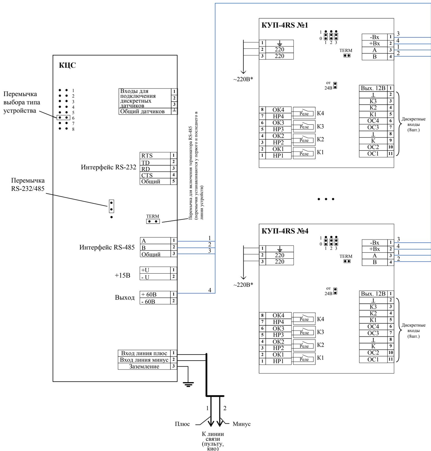
**Рис. Б 2.5.4-3** Схема подключения концентратора управляющего КУП-4RS к концентратору цифровых сигналов КЦС.
