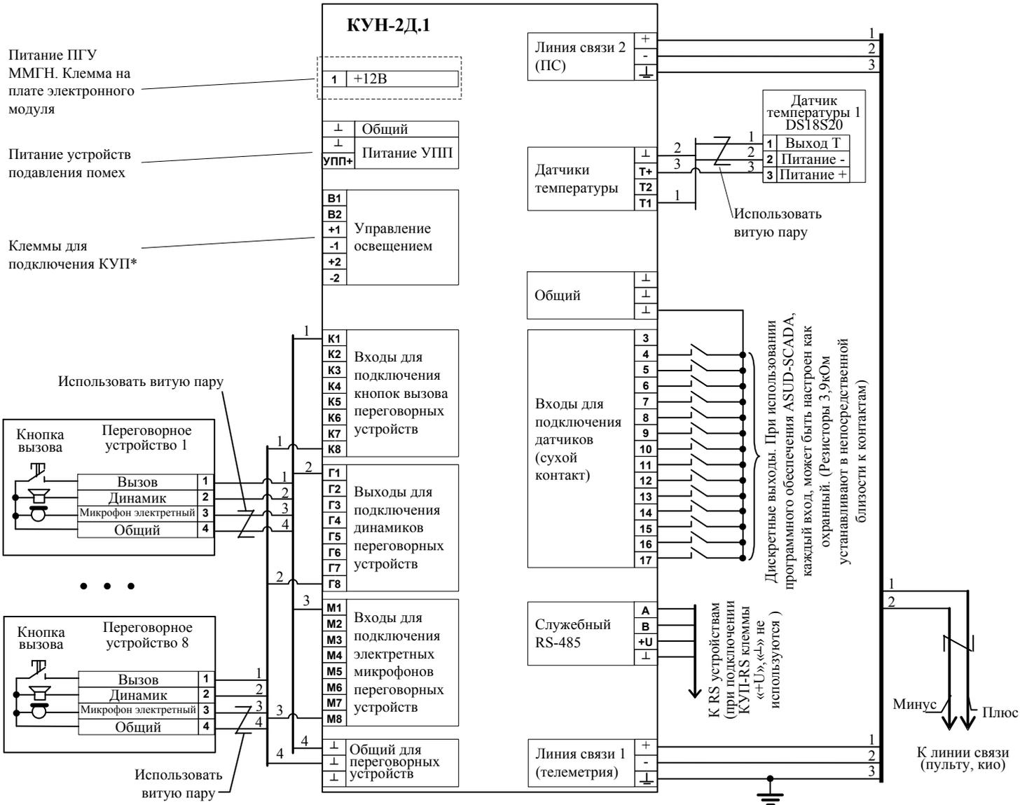
Рис. Б 2.1.1-4 Схема подключения КУН-2Д.1 для двухпроводной линии связи.
