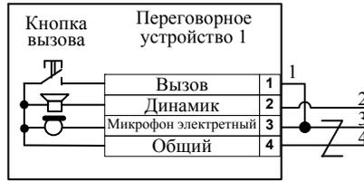
Переговорное устройство допускается подключать используя 3 жилы кабеля. В этом случае на клеммнике переговорного устройства соединить входы 1 «Вызов» и 3 «Микрофон электретный», а на клеммнике КУН-2Д.1 соединить соответствующие входы К «Вызов» и М «Микрофон электретный».
