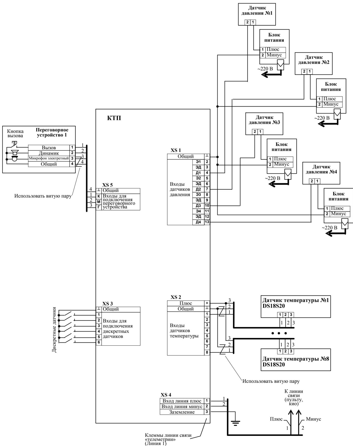
**Рис. Б 2.8.2** Схема подключения концентратора теплового пункта (КТП) (вариант 2).
