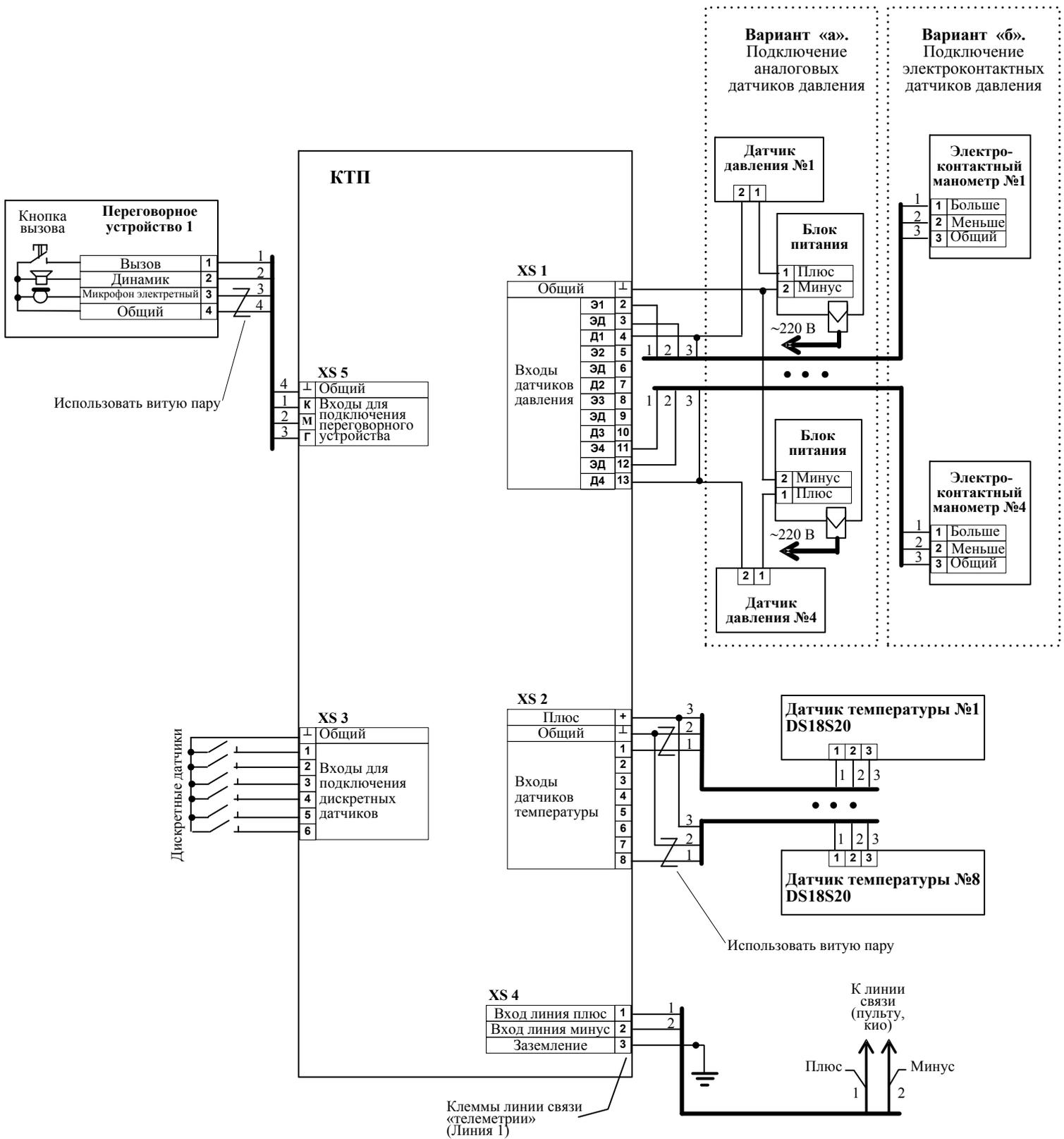
**Рис. Б 2.8.1** Схема подключения концентратора теплового пункта (КТП) (вариант 1).
