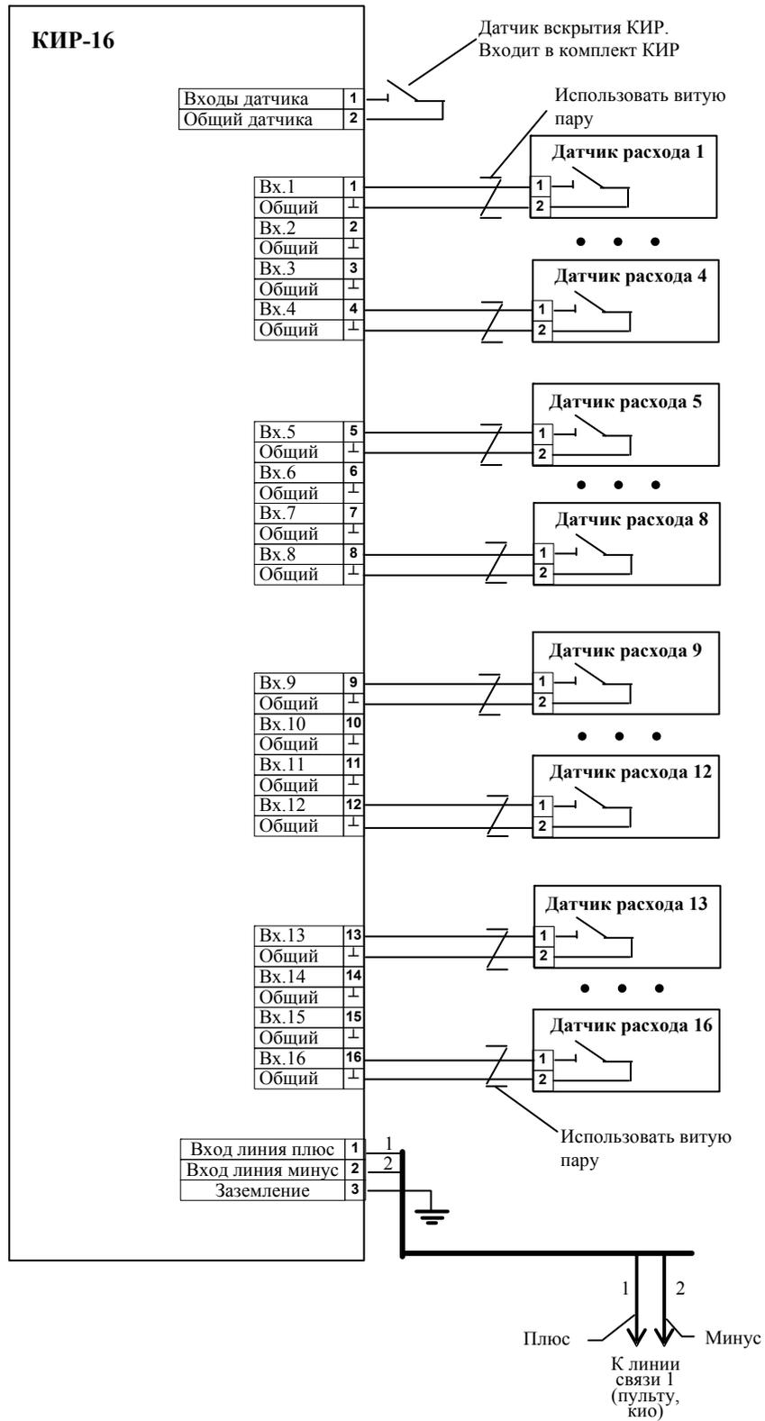
Рис. Б 2.14.1 Схема подключения концентратора измерителей расхода (КИР-16).
