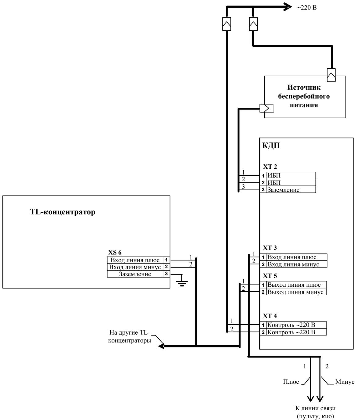
**Рис. Б 2.9.1** Схема подключения концентратора дополнительного питания (КДП). КДП используется при подключении концентраторов по 2-х. проводной линии связи. Не подключать концентраторы между разъемом XT3 КДП и пультом АСУД-248 ПК, КИО.
