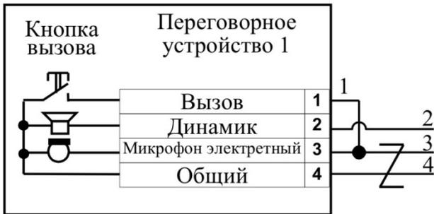
Рис.1. 3-проводная схема
