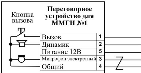
Рис.3. 5-проводная схема
