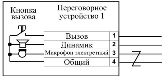
Рис.2. 4-проводная схема
