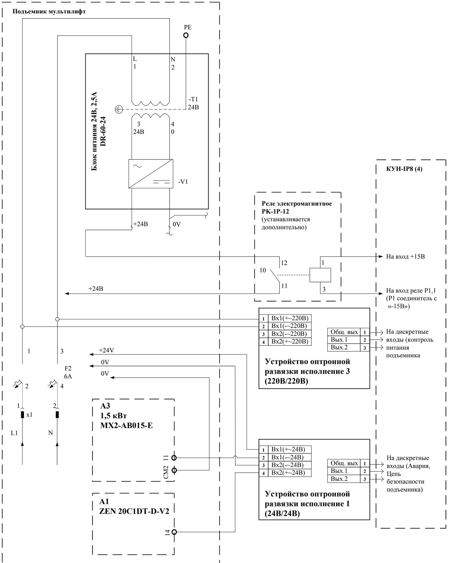
**Рис. Б 4.3.9** Схема подключения КУН-IP8 (4) к подъемным платформам Мультилифт.
