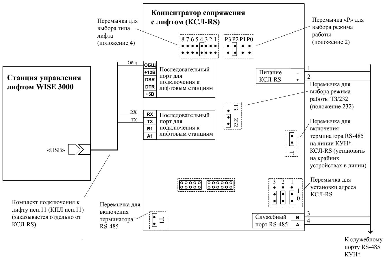
**Рис. Б 4.1.29** Схема подключения КСЛ-RS к станции управления лифтом WISE 3000
