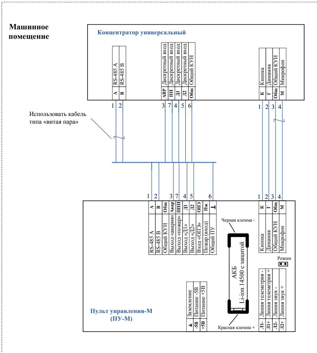
**Рис. Б 2.20.6** Подключение Устройства переговорной связи лифта - М исполнение 2 (УПСЛ-М исп.2) к Концентратору универсальному (КУН) любого типа.
