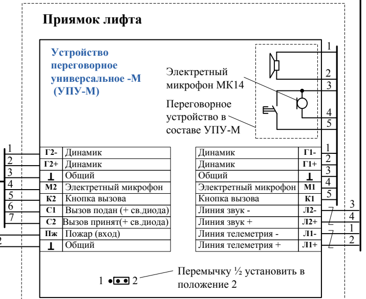
Рис. Б 2.20.4 Устройство переговорной связи лифта - М исполнение 2 (УПСЛ-М исп.2). В комплект входит ПУ-М – 1 шт., УПУ-М – 2 шт., ПККЛ-М – 1 шт., ПГУ-М ОПЭ – 1 шт.). Основные функции: связь лифта для пожарных, ремонтная связь лифта, связь с помещением для обслуживающего персонала.
