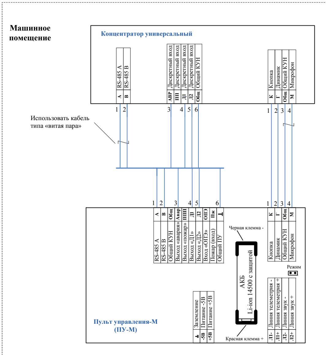
**Рис. Б 2.20.5** Подключение Устройства переговорной связи лифта - М исполнение 1 (УПСЛ-М исп.1) к Концентратору универсальному (КУН) любого типа.
