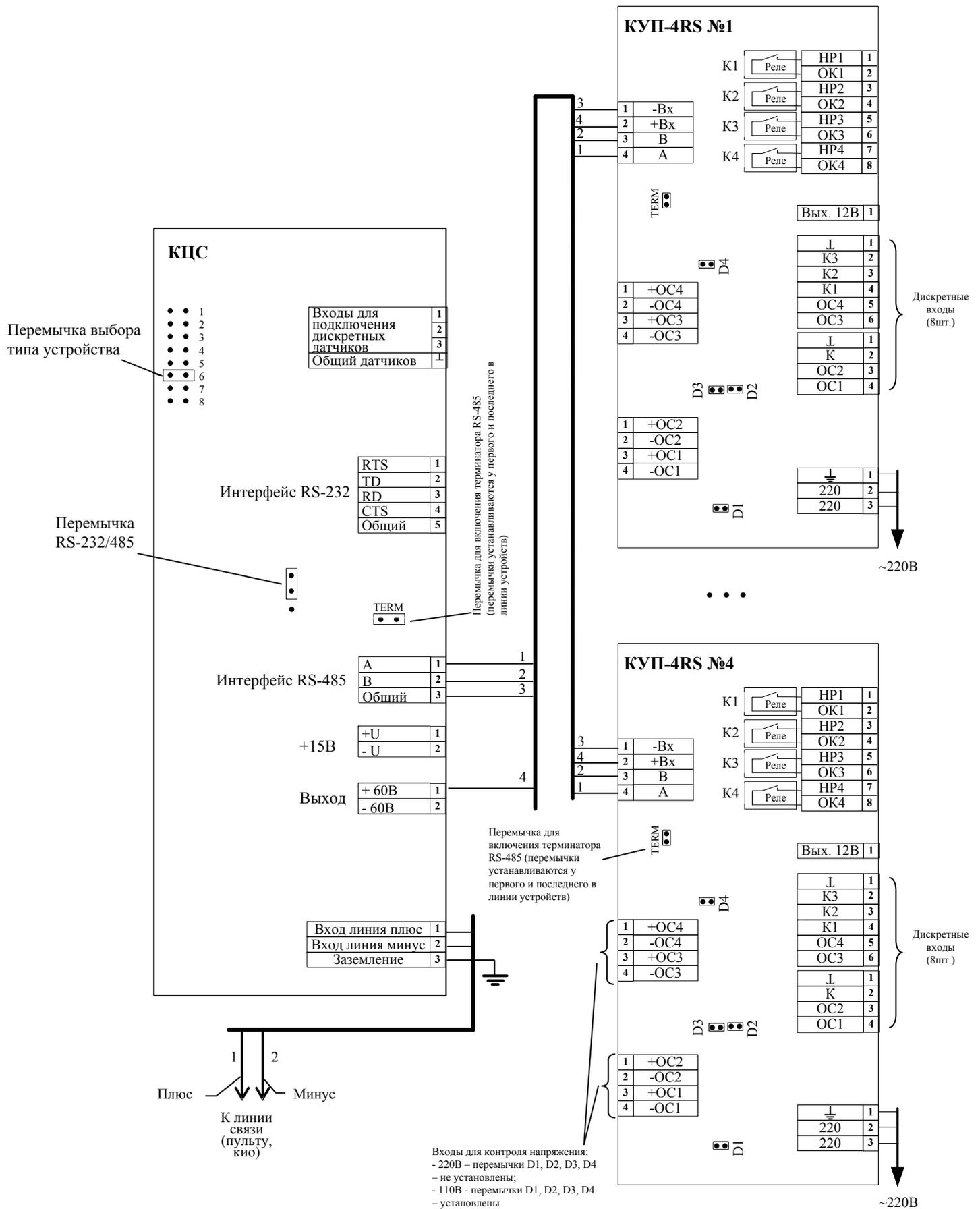
**Рис. Б 2.5.4-2** Схема подключения концентратора управляющего КУП-4RS к концентратору цифровых сигналов КЦС. Схема действительна для КУП-2RS.
