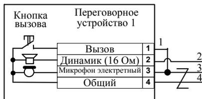
Переговорное устройство допускается подключать используя 3 жилы кабеля. В этом случае на клеммнике переговорного устройства соединить входы 1 «Вызов» и 3 «Микрофон электретный», а на клеммнике КУН-IP4 соединить соответствующие входы К «Вызов» и М «Микрофон электретный».
