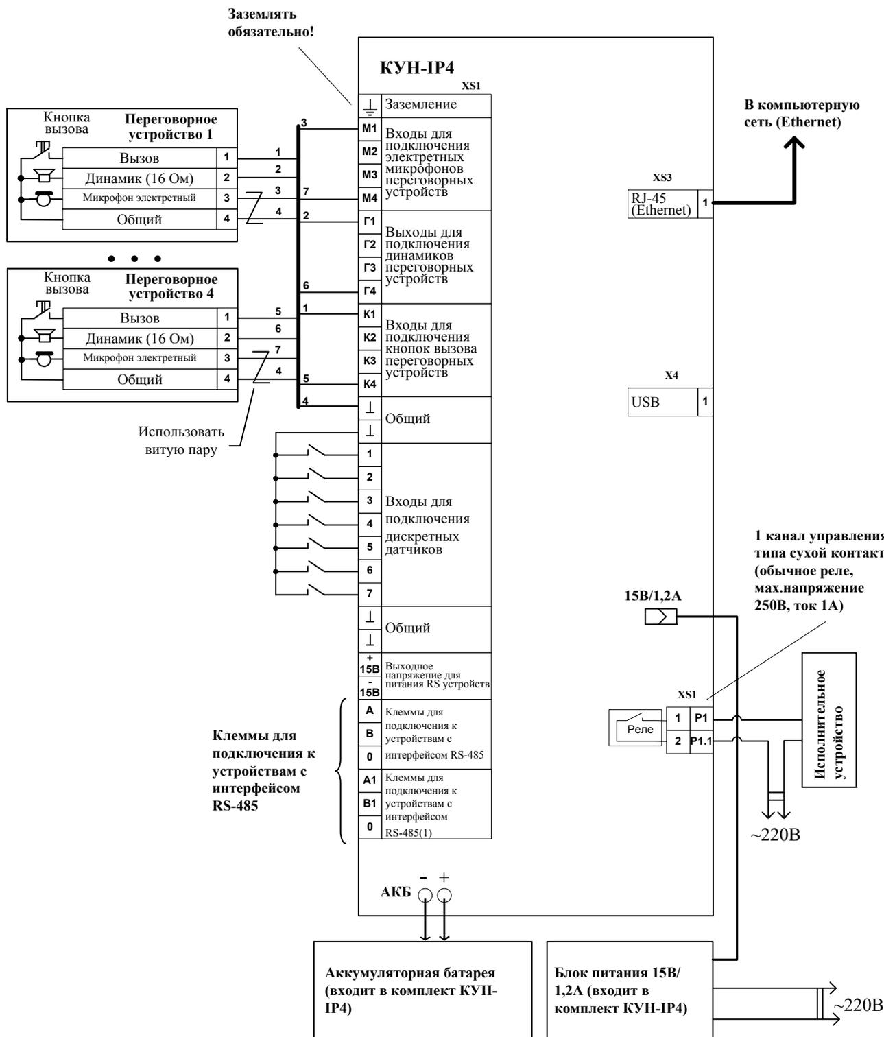
**Рис. Б 2.3.2-2** Схема подключения концентратора универсального – IP4 (КУН-IP4).
