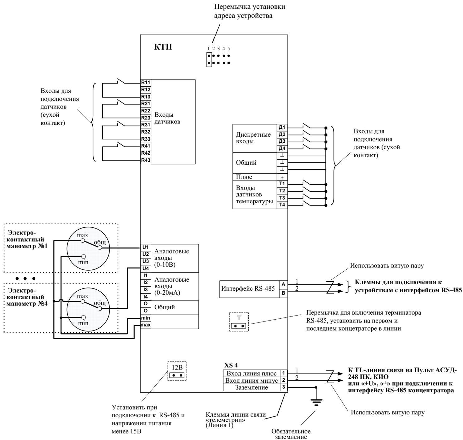
**Рис. Б 2.8.2-2** Схема подключения концентратора теплового пункта (КТП) (вариант 2).
