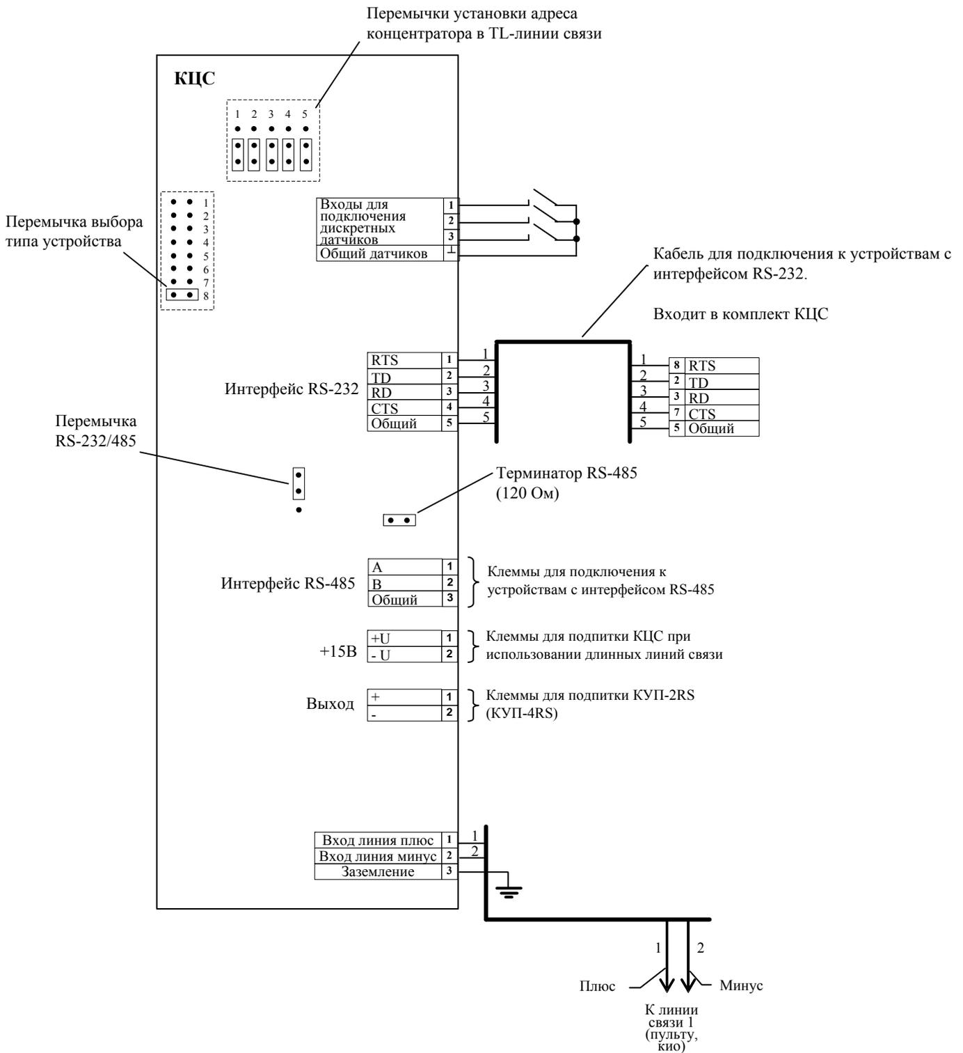
Рис. Б 2.18.1-2 Схема подключения концентратора цифровых сигналов (КЦС).
