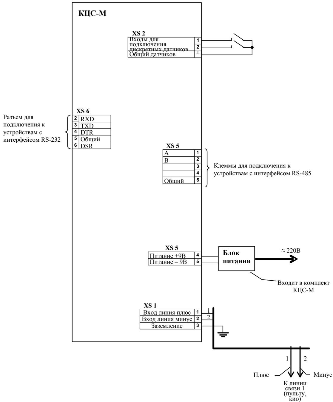
**Рис. Б 2.18.2** Схема подключения концентратора цифровых сигналов (КЦС-М) (RS-485).
