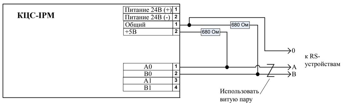
Рис.Б 2.19.1-3 Схема подключения концентратора цифровых сигналов ИРМ (КЦС-ИРМ).
