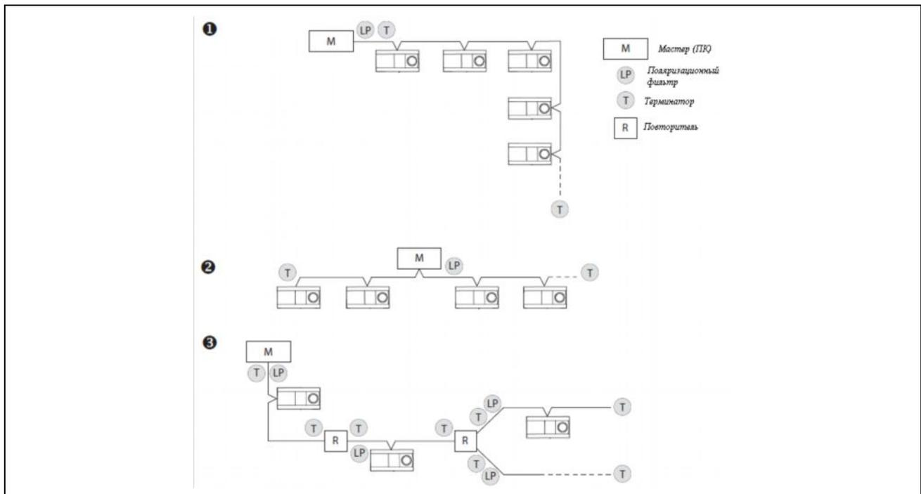
Рис. 4-2: Три схемы последовательного подключения к сети.
