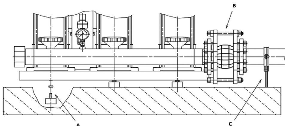
Трубопроводы, на которые устанавливаются компенсаторы (B), не должны иметь осевых перекосов. Недопустимо выравнивание несоосностей или смещения труб за счет компенсаторов. При установке компенсатора болты следует затягивать равномерно крест-накрест. На резиновые детали компенсаторов нельзя наносить краску. В установке всегда должен быть свободный доступ к компенсаторам для их контроля, поэтому компенсаторы не должны быть закрыты изоляцией трубопроводов.
